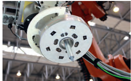
Bild 1: Für automatisierte, hochpräzise Kleb- und Dichtprozesse: konzentrische Multifunktionssensorik arrangiert um die Applikationsspitze (Bild: Fraunhofer IFAM, Stade)
