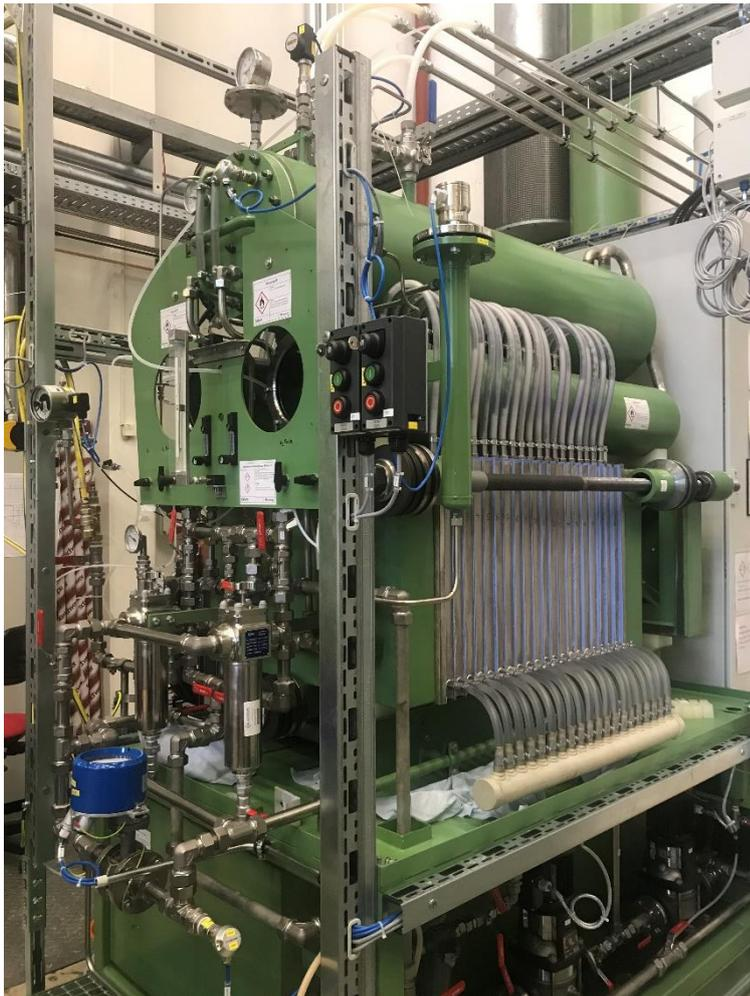
Bild 2: Industrieller alkalischer atmosphärischer Testelektrolyseur am Fraunhofer IFAM Dresden
