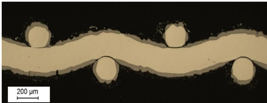
Bild 1: Querschnittsaufnahme eines Raney-Nickel-beschichteten Metall-Substrates (Gitterstruktur).
