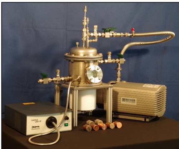
Versuchsstand zur messtechnischen Charakterisierung von Verdampferoberflächen
