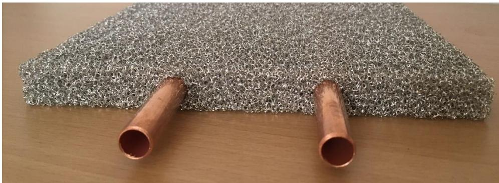
*Zellulare Struktur mit integriertem Wärmeträgerrohr als Grundlage für die
