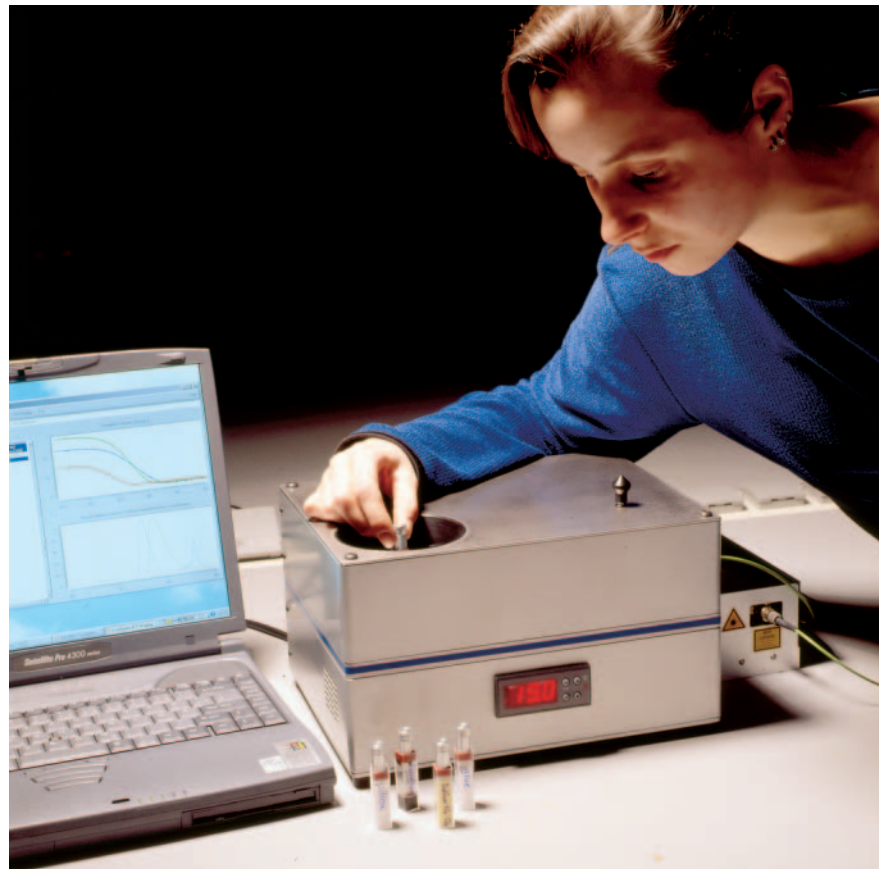
Abb. 4: Zur Messung der Partikelgrößenverteilung entwickeltes Lichtstreugerät.
