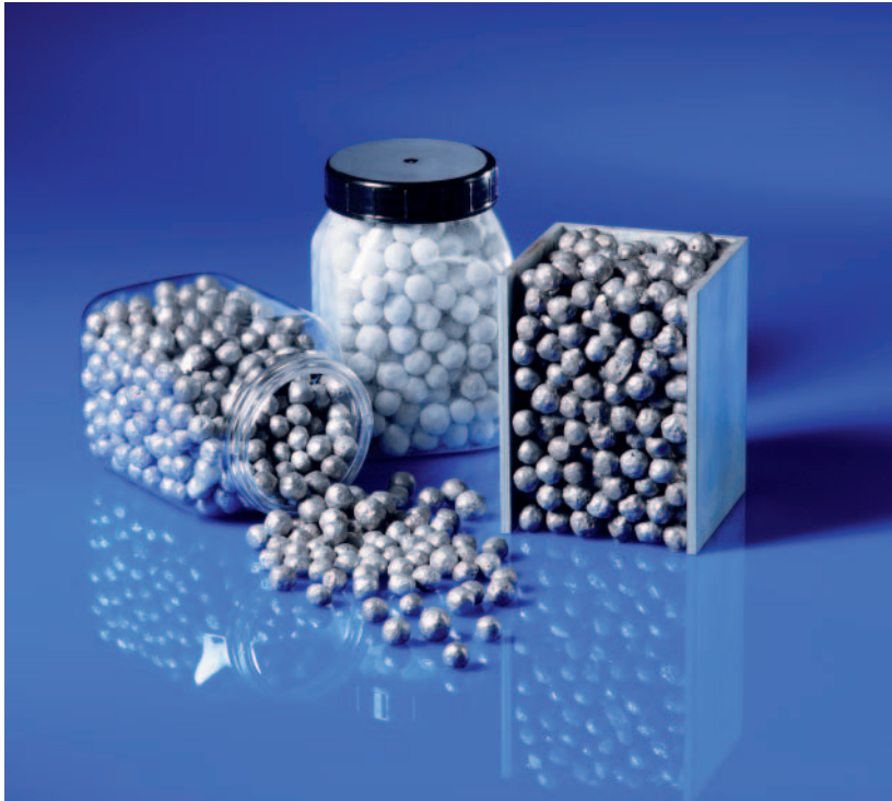
Abb. 2: APM-Aluminiumschaumelemente (links) mit Klebstoffbeschichtung (Mitte) und ein gefülltes Hohlprofil (rechts).
