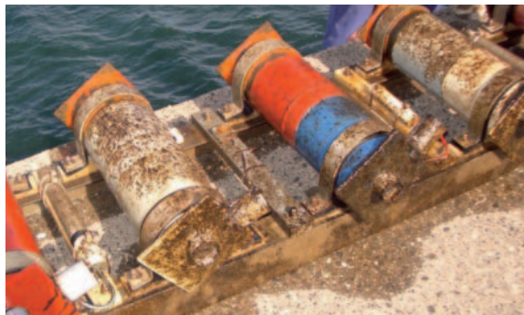
Abb. 4: Praxisnahe Bewertung von neuen Korrosionsschutzsystemen für Offshore-Stahlstrukturen. Das linke Bild zeigt Prüfkörper mit unterschiedlichen Beschichtungssystemen und Strukturelementen vor einer Auslagerung im Wechsellagerbereich in der Nordsee bei Helgoland. Das rechte Bild zeigt die gleichen Prüfkörper nach 30-monatiger Auslagerung. Die Prüfkörper zeigen deutliche Korrosionserscheinungen.
