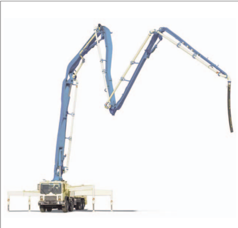
Abb. 1: Betonpumpe mit ausgefaltetem Verteilermast.
