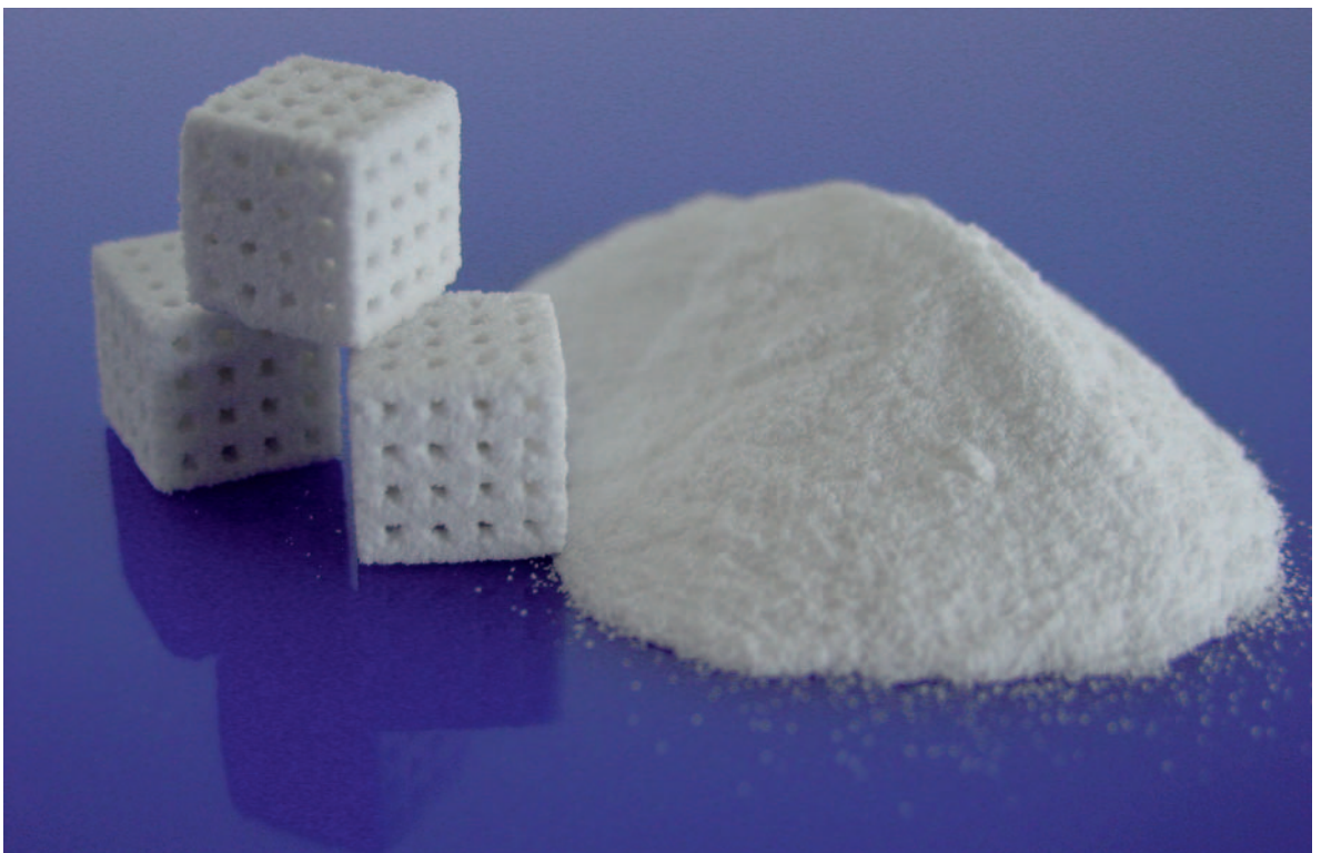
Abb. 10: Gedruckte Strukturen aus resorbierbarem Knochenmaterial für Implantatanwendungen.
