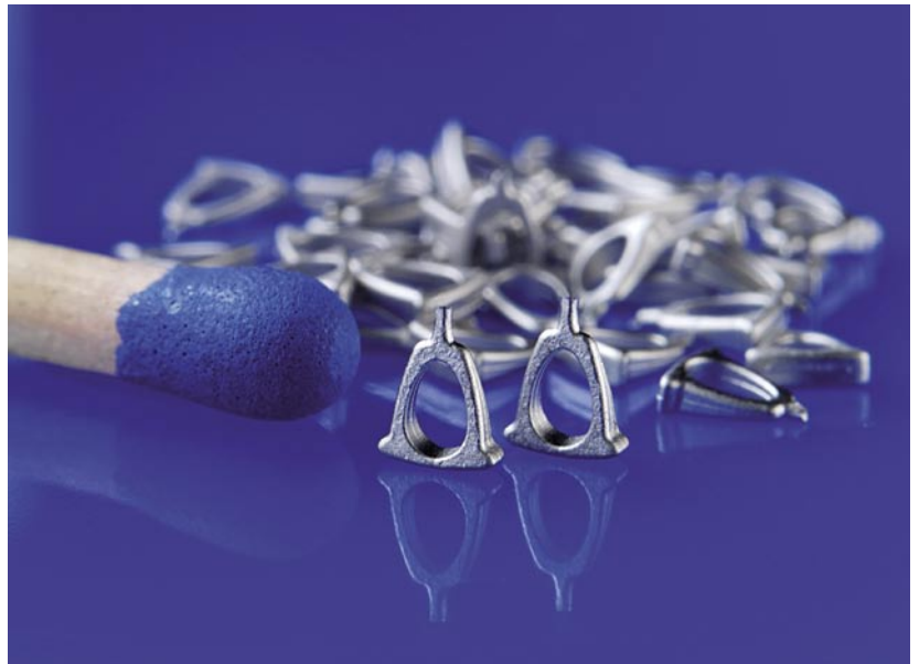
Abb. 8: Serienfertigung von Steigbügeln aus 316L (Kooperation mit der Firma Krämer Engineering, Rendsburg).
