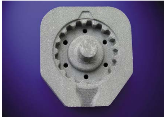
Abb. 2: Dichtgesinterter gedruckter Werkzeugeinsatz aus M2-Werkzeugstahl.
