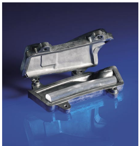
Abb. 1: Halbzeug in der Schäumform.
