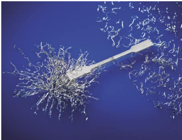
Abb. 2: Mikrozugprobe aus der Kombination von 316L mit 17-4PH. Der linke Teil der Probe aus 17-4PH wurde aufmagnetisiert und zieht die Eisenfasern an. Der rechte Teil der Probe bleibt dabei unmagnetisch.
