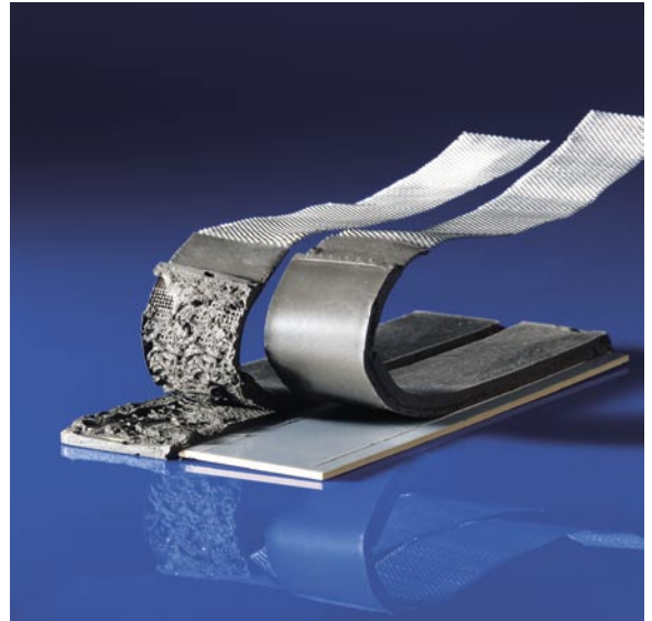
Abb. 2: Die linke Probe zeigt einen Kohäsionsbruch in der Klebschicht, die rechte Probe einen Adhäsionsbruch, der durch eine am IFAM entwickelte Trennschicht verursacht wurde.
