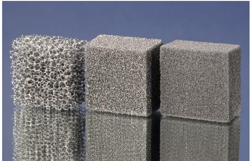
Abb. 2: Offenzellige Metallschäume aus Edelstahl 316L mit Zellweiten von 20, 45 und 60 ppi.
