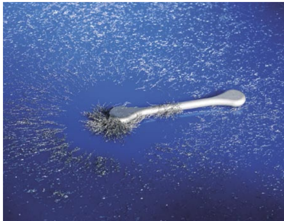
Abb. 3: 2K-MIM-Zugprobe aus dem rostfreien, austenitischen Edelstahl 316L und dem harten, martensitischen Warmarbeitsstahl H13. Der H13 wurde aufmagnetisiert, so dass er auf dem Bild die Eisenspäne entlang der Feldlinien ausrichtet und sie anzieht. Der Edelstahl ist unmagnetisch und übt keinen Einfluss auf die Späne aus.
