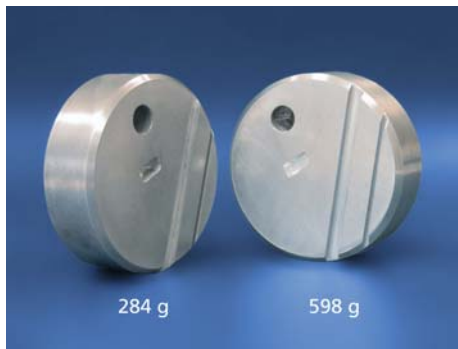
Vergleich der Massen von Zinkbauteilen mit (links) und ohne 3M-S60-Glashohlkugeln (rechts).
