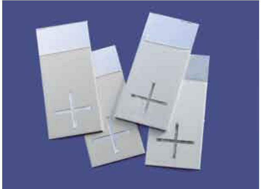
Abb. 5: Probenkörper für elektrochemische Rauschmessungen.
