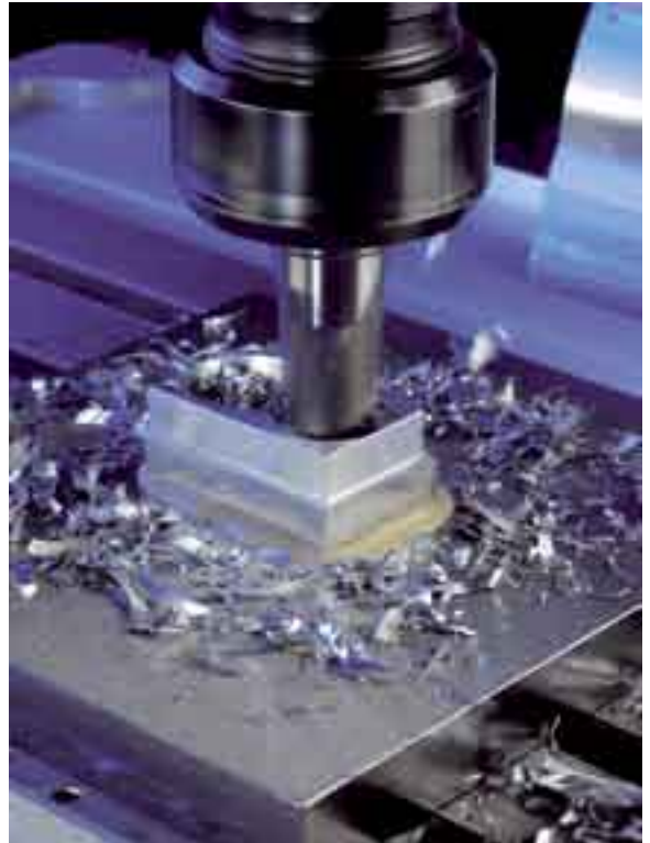
Das Werkstück wird für die spanende Beanspruchung direkt auf den Spanntisch geklebt.
