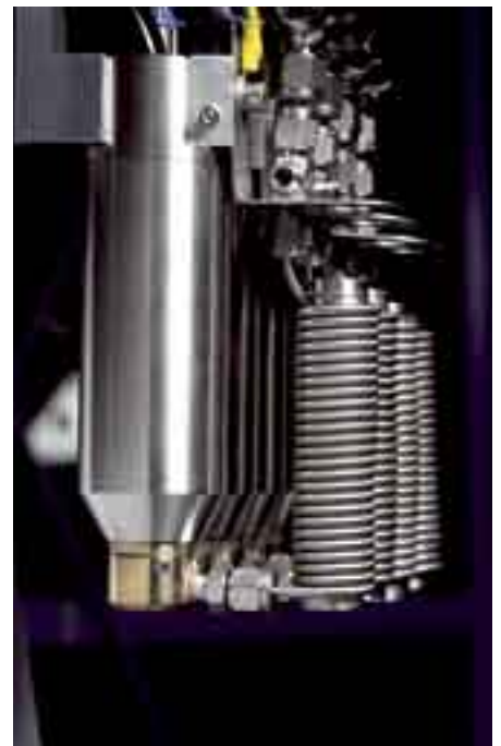
Abb. 1: Atmosphärendruck-Plasmatechnologie (Anlagenhersteller: Plasmatrete); links: Prinzipskizze, rechts: Plasmadüse für Plasmapolymerisation.
