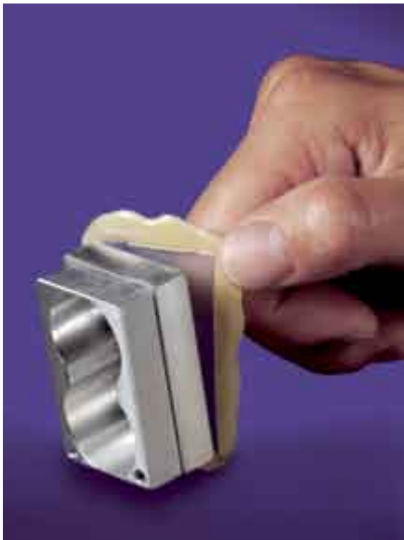
Nach dem Lösen der Klebverbindung kann der Klebstoff leicht per Hand vom Werkstück abgezogen werden.
