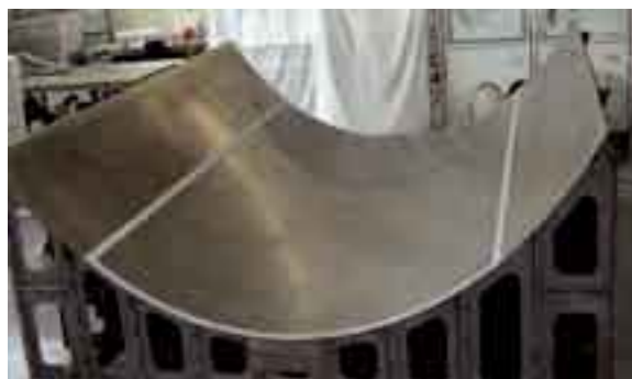
Abb. 4: Potenzielle Anwendung für plasmapolymere Atmosphärendruck-Trennschichten: Formwerkzeug zur CFK-Bauteilherstellung nach dem Prepreg-Verfahren.
