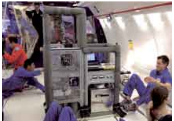
Abb. 3: Eine von Novespace in Bordeaux betriebene A300 ermöglicht in 30 aufeinanderfolgenden Parabeln jeweils 20 Sekunden dauernde Versuche unter »Fast-Schwerelosigkeit« (typisch \pm 0,02 g) für etwa 15 verschiedene Experimente. Oben: Die furchtlosen Forscher; Mitte: A300 im Steigflug (»injection phase«); unten: IFAM-Versuchsapparatur (Bildquelle: ESA).
