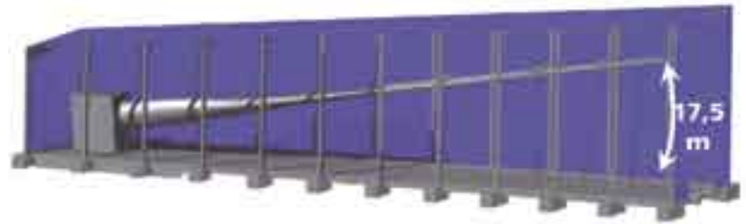
Prüfstand für die statische und zyklische Untersuchung von Rotorblättern bis zu 70 m Länge. Das maximale Drehmoment beträgt 50 Mega-Newtonmeter.
