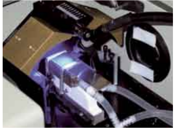
Abb. 2: Versuchsaufbau der Reaktionsverfolgung UV-härtender Systeme bei definierter Temperatur mit IR-Spektroskopie in gerichteter Reflexion.
