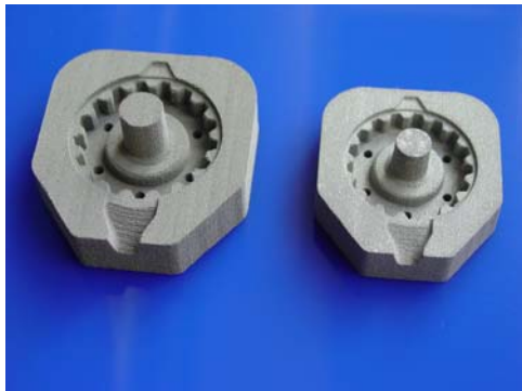
Gedrucktes Grünteil (links) und dichtgesintertes HS 6-5-2 Werkzeugstahl Bauteil (rechts)
