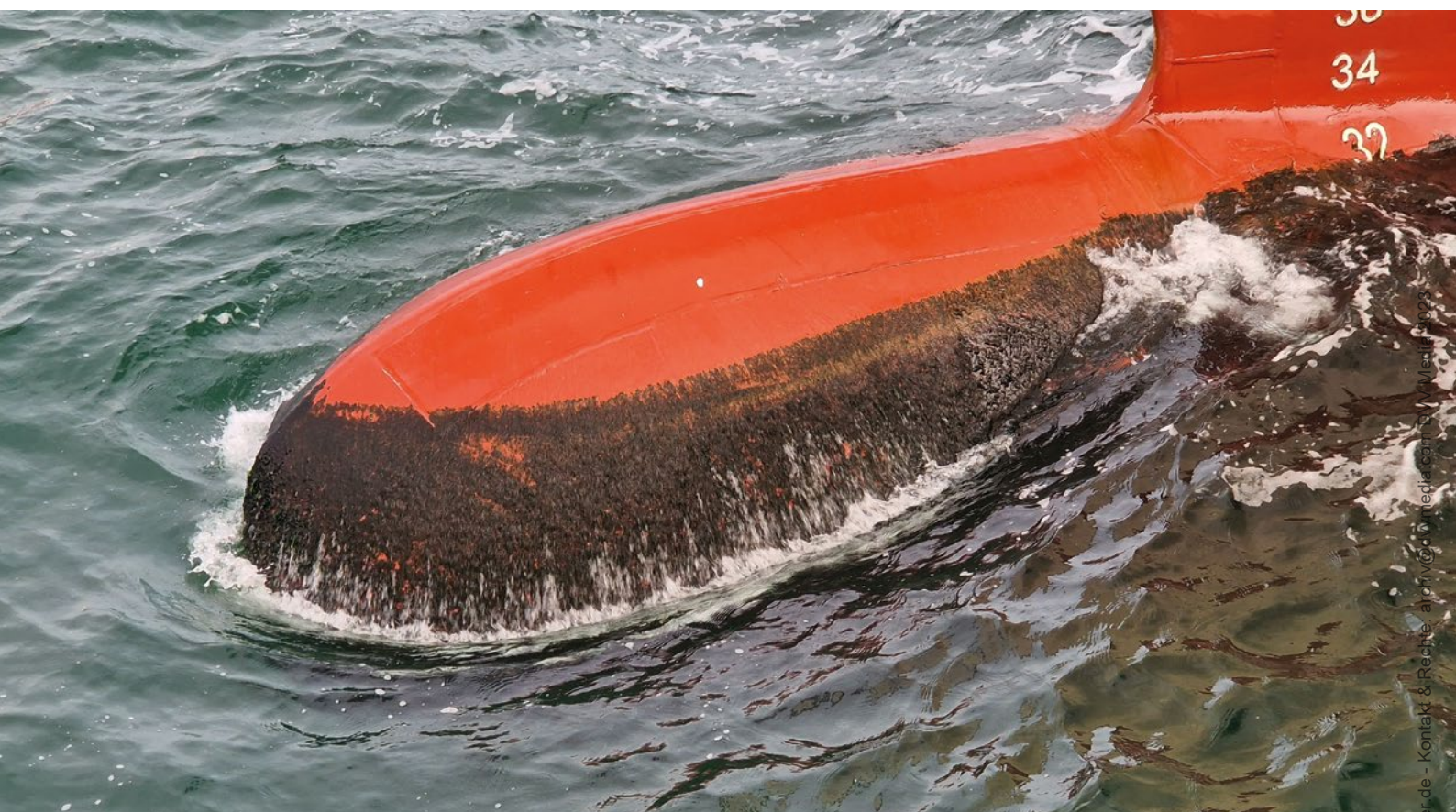
Schiffsbug mit Bewuchs im Unterwasserbereich
