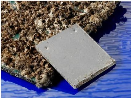
Beispiel für einen biozidfreien Bewuchsschutz nach erfolgter Reinigung im Vergleich zur nicht geschützten Probe. © Fraunhofer IFAM
