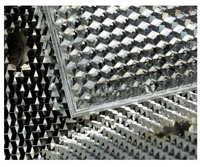
UltraPLAS® ermöglicht eine perfekte Abbildung spiegelglänzender Oberflächen. Trennbeschichtetes Werkzeug (l.) mit spritzgegossenem Element. © Fraunhofer IFAM/Wolfgang Hielscher
