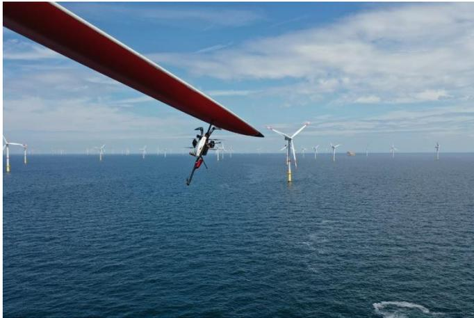
Kontrolle des Blitzschutzsystems einer Windkraftanlage im Offshore-Windpark mit einer Drohne in ca. 100 m Höhe. Riskante Arbeiten für Menschen, wie diese Inspektion, können in Zukunft vermehrt mit unbemannten Systemen realisiert werden. © Voliro AG / Fraunhofer IFAM
