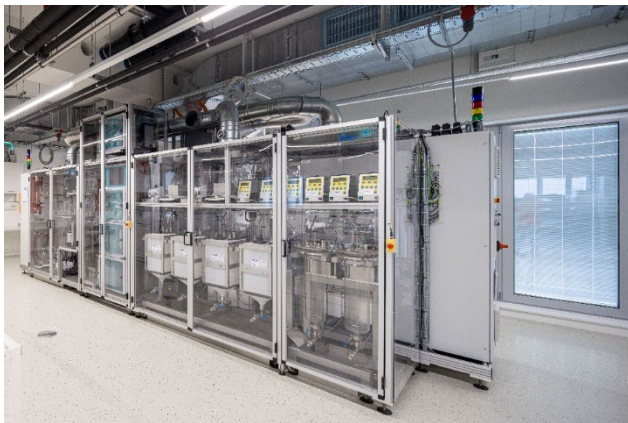
Powder-Up! Pilotanlage zur Herstellung von Aktivmaterialien für Natrium-Ionen-Batterien. © ZSW Ulm
