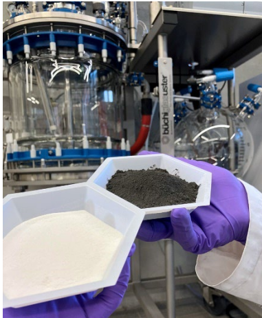
Lab-Scale Fällungsreaktor zur Entwicklung eines Aktivmaterials für Natrium-Ionen-Batterien. © Fraunhofer IFAM
