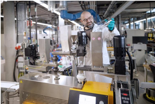
Abb. 1 Am Fraunhofer IFAM werden die gereinigten Kunststoffabfälle im Compounder gemischt, aufgeschmolzen und extrudiert
