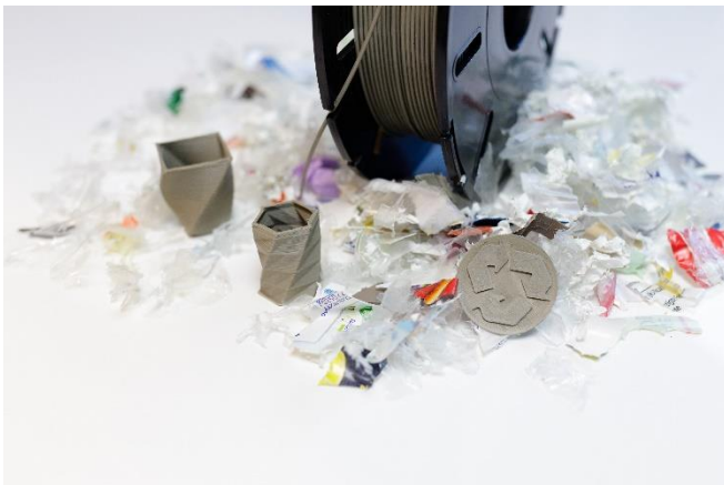
Abb. 2 Aufbereitetes Material für die additive Fertigung: Die Post-Consumer-Abfälle werden zu Filament für den 3D-Drucker
