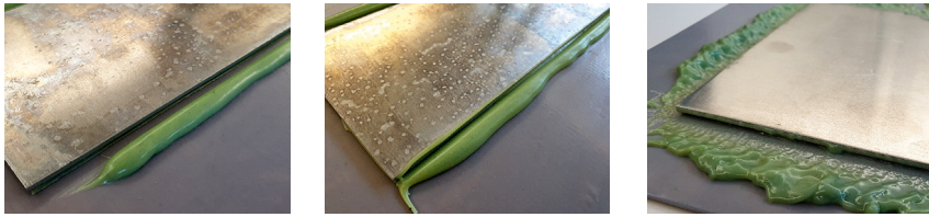
Bild 9: Ergebnisse einer Versuchsreihe zum automatisierten Entfernen von Squeeze-Out (v.l.n.r. mittels Spachtel, Dorn bzw. Druckluft) (Bild: Fraunhofer IFAM)
