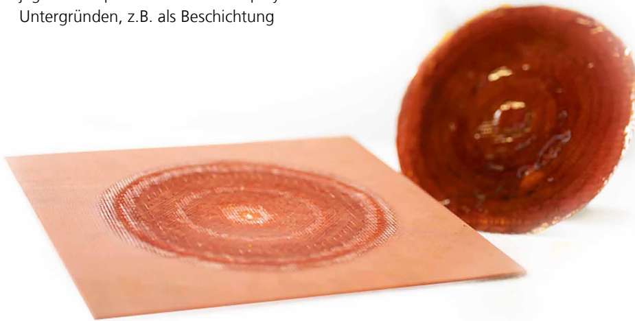
Vitrimer-Patch und Schäftung. Reparaturen ohne Reaktivharz.
